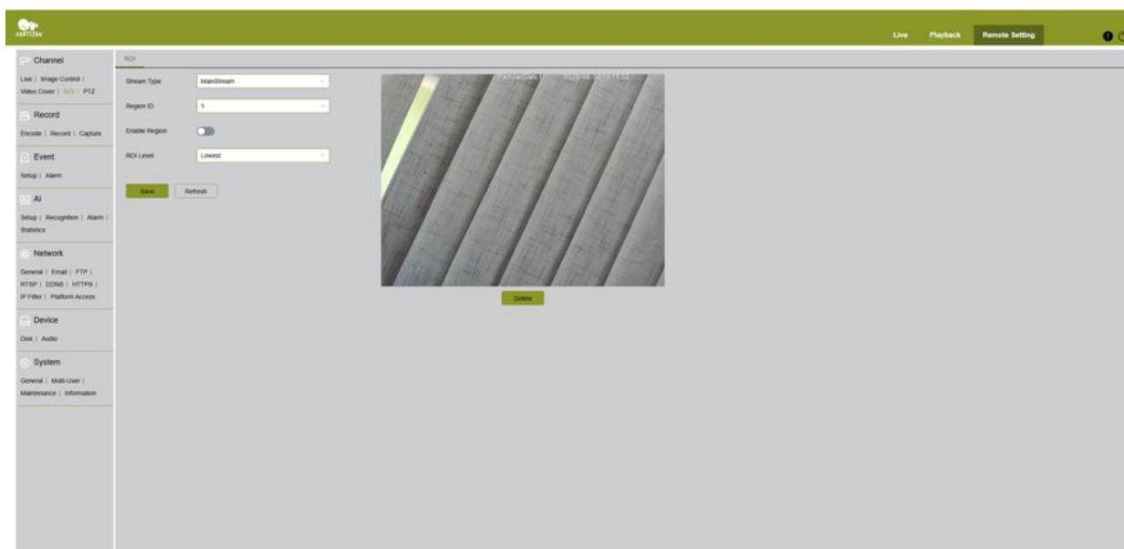
Fig. 21. Canale → ROI — tipo di flusso, selezione dell'area e livello di qualità della ROI
