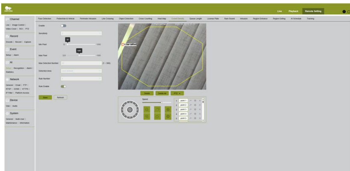
Fig. 45. AI → Configurazione → Densità della folla — area di rilevamento definita dall'utente e numero massimo di rilevamenti
