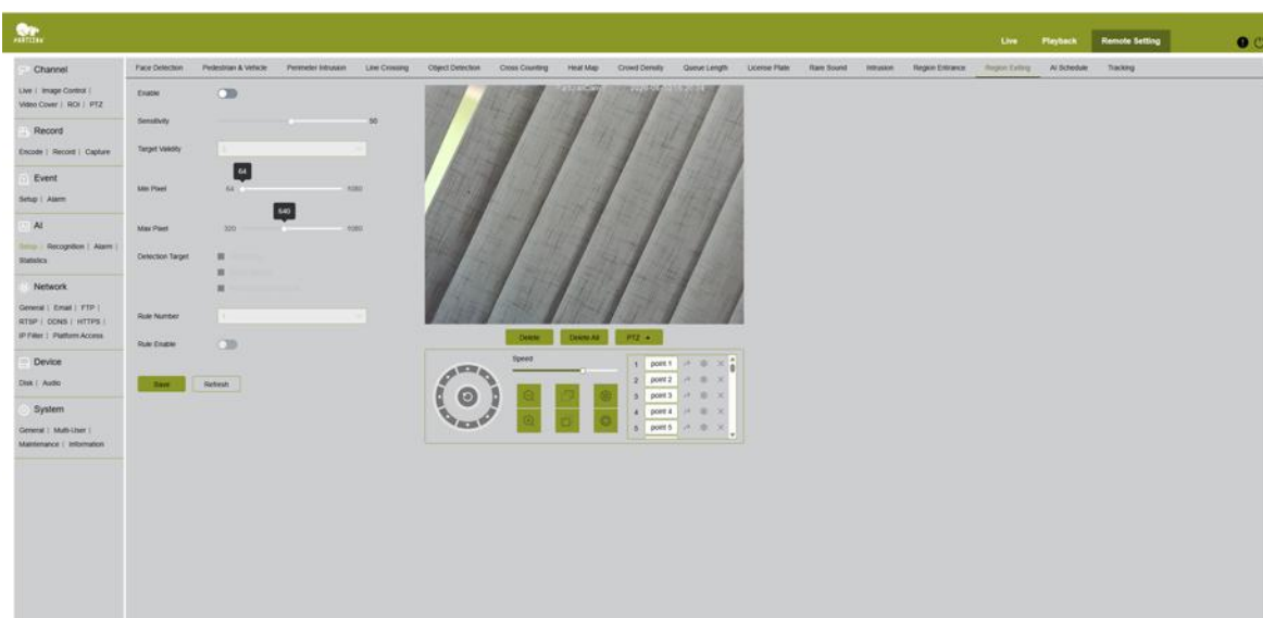
Fig. 51. AI → Configurazione → Uscita dall'area — sensibilità, validità del bersaglio, intervallo di pixel, bersaglio di rilevamento e area della regola
