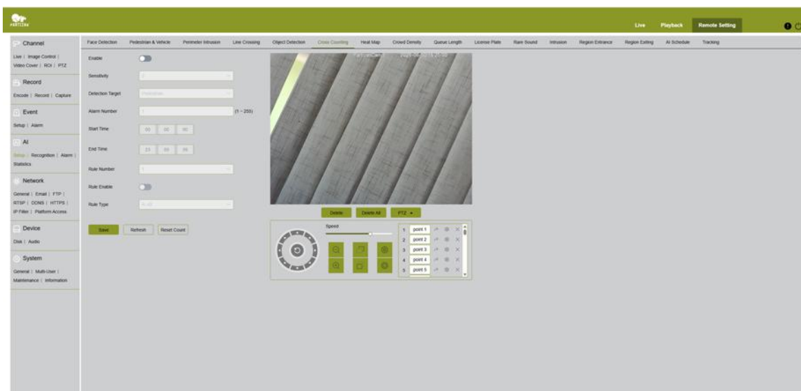
Fig. 43. AI → Impostazioni → Conteggio degli attraversamenti — conta gli attraversamenti per tipo di bersaglio, con ora di inizio/fine e opzione di azzeramento
