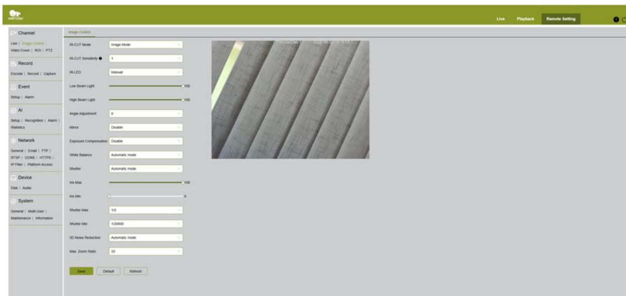
Fig. 19. Canale → Controllo immagine — Impostazioni IR-CUT, esposizione, bilanciamento del bianco, otturatore e riduzione del rumore
