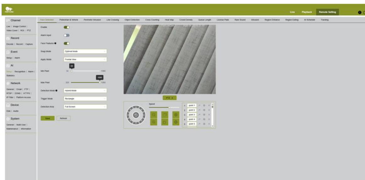
Fig. 38. IA → Impostazioni → Rilevamento volti — modalità scatto, modalità applicazione, intervallo di pixel, modalità di rilevamento e modalità di attivazione
