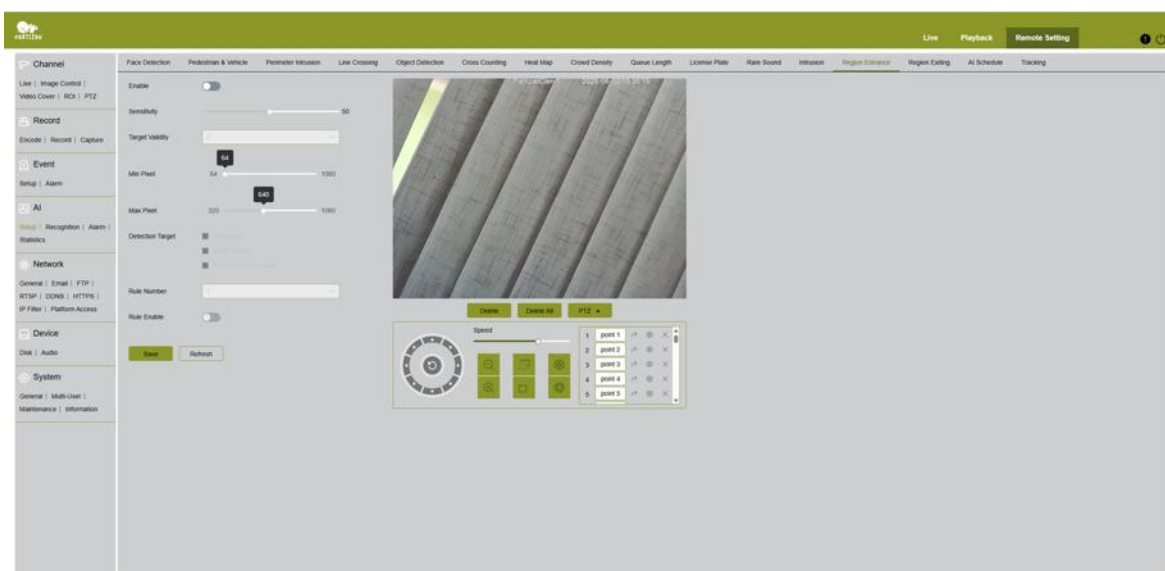
Abb. 50. KI → Einrichtung → Bereichseingang – erkennt Objekte, die einen definierten Bereich betreten
