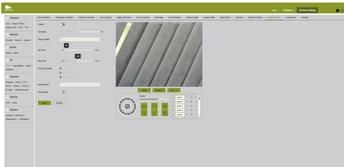
Obr. 51. AI → Nastavení → Opuštění oblasti — citlivost, platnost cíle, rozsah pixelů, detekční cíl a oblast pravidla
