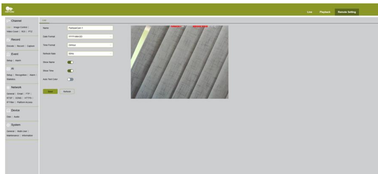
Rys. 18. Kanał → Obraz na żywo — nazwa, format daty/godziny, częstotliwość odświeżania i przełączniki nakładania
