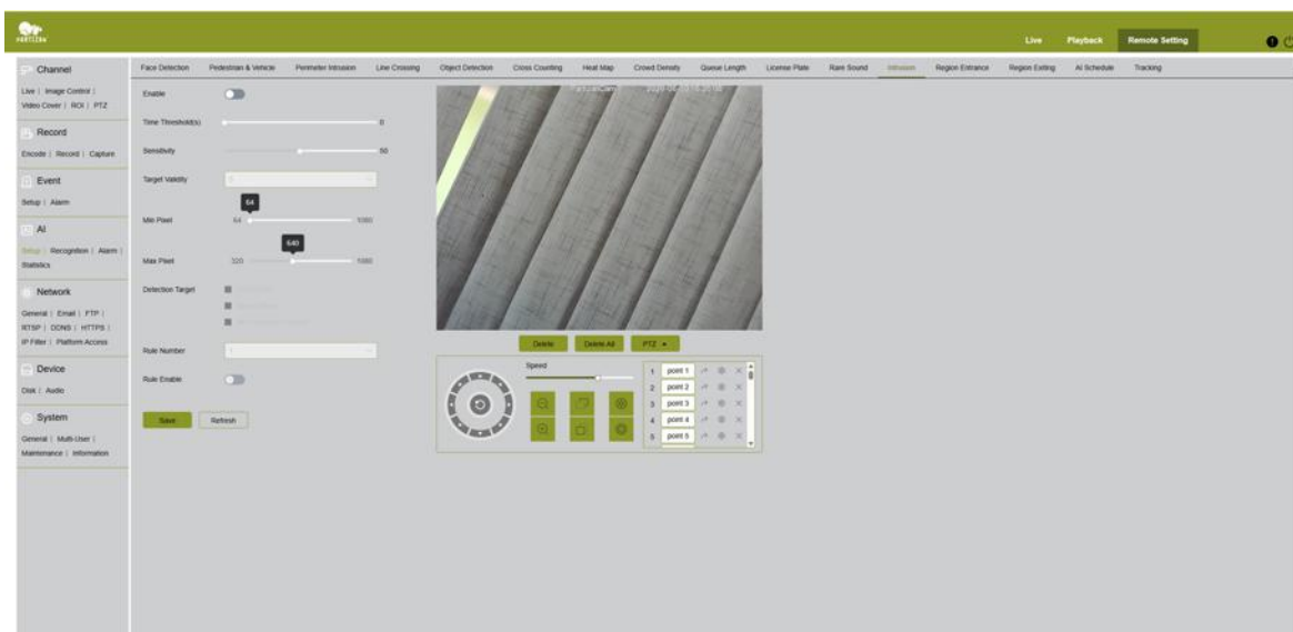
Rys. 49. AI → Konfiguracja → Wtargnięcie — próg czasowy, czułość, ważność celu i obszar reguły
