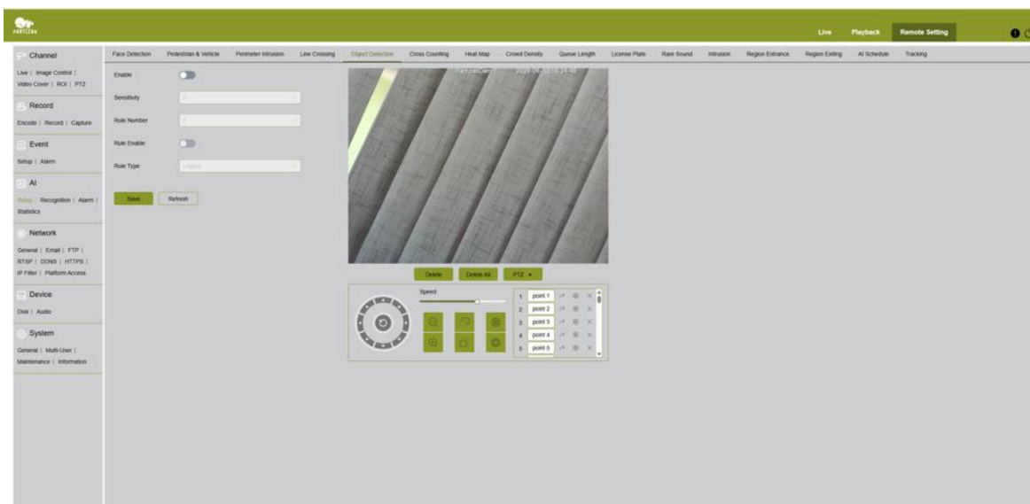
Fig. 42. IA → Configuración → Detección de objetos: detecta objetos abandonados o retirados dentro de un área definida por la regla
