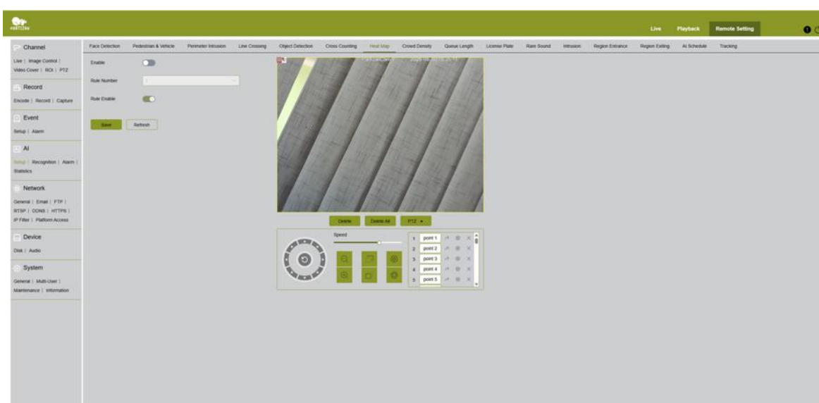
Fig. 44. IA → Configuración → Mapa de calor: habilita el seguimiento de la densidad de actividad espacial para la región de la regla seleccionada
