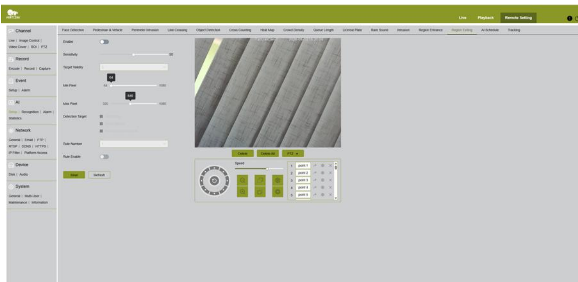
Fig. 51. IA → Configuración → Salida de la zona: sensibilidad, validez del objetivo, rango de píxeles, objetivo de detección y área de la regla
